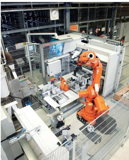
2 Mit der Roboter-Anbindung ‚KastoSort‘ hat Kasto eine Lösung im Portfolio, mit der sich auch nachgelagerte Fertigungsprozesse automatisieren lassen © Kasto Maschinenbau
